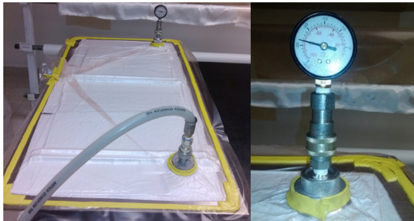
Figura 3.13 Bolsa sellada con aplicación de vacío.
