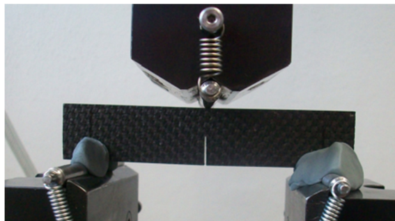
Figura 3.21 Arreglo de accesorios y probeta SENB para ensayo de tenacidad cuasiestática.
