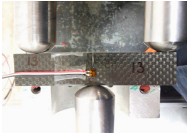
Figura 3.24 Arreglo de barras de Hopkinson con probeta tipo SENB.
