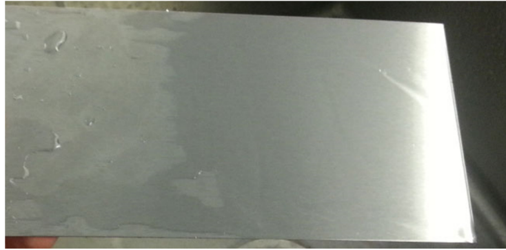
Figura 3.6 Prueba de rompimiento de gota en lámina de aluminio 2024-T3.
