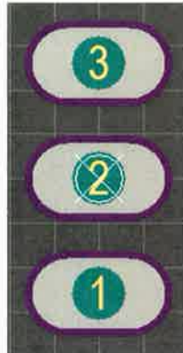
Figure 2.20. Etapa 1, colocación de pads.
