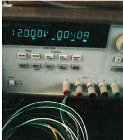
Figura 4.11: Voltaje de alimentación de la tarjeta A
