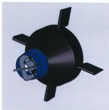
FIGURA 57 Vistas de la cola del AUV, con el propulsor y los alerones de dirección.
