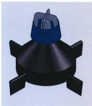
FIGURA 57 Vistas de la cola del AUV, con el propulsor y los alerones de dirección.
