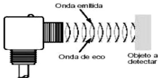
Figura 22.- Funcionamiento de un sensor ultrasónico.
