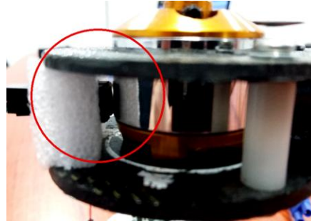
Figura 52.- Alineación del sensor CNY70 en la medición de PWM.
