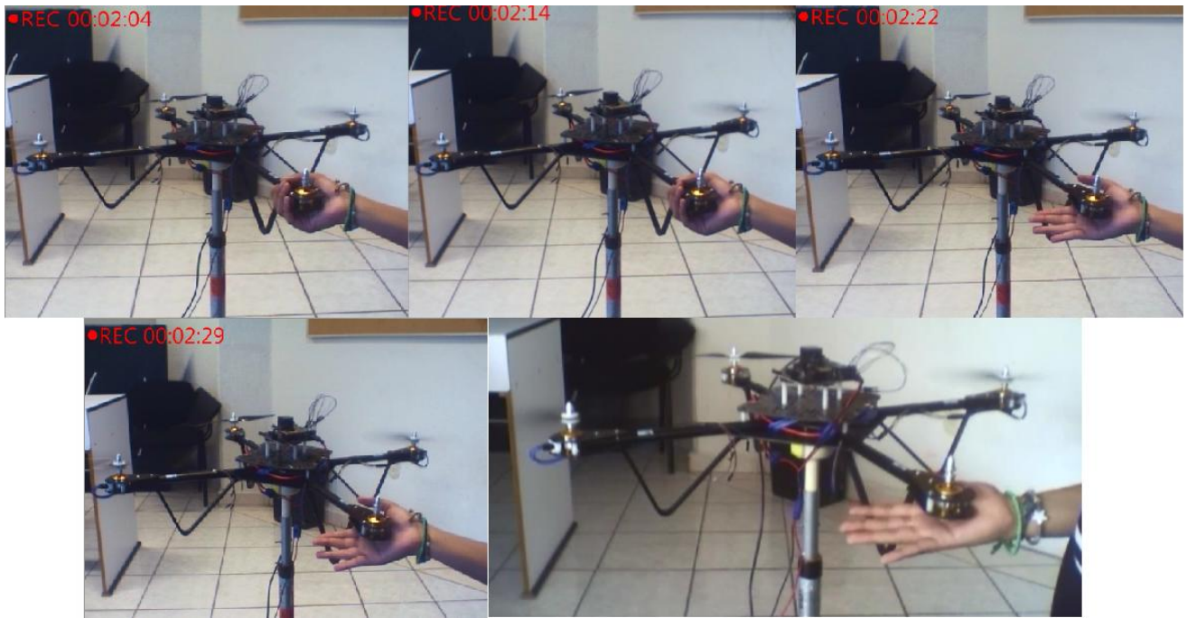
Figura 68.- Control PID con K_p = 0.5 , K_i = 0.01 y K_d = 0.01 .
