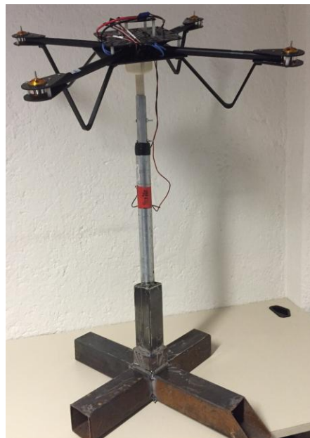
Figura 64.- Estructura de acero galvanizado para pruebas con cuadricóptero.
