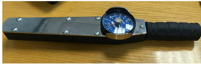
Figura 14. Torquímetro CDI modelo 502 LDFN.
