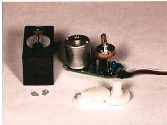
Figura 2.2.- Composición de un Servomotor
