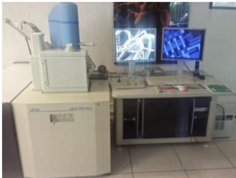
**Figura 3.33** Microscopio electrónico de barrido JSM-6610LV
