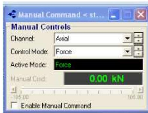
**Figura 3.21** Control manual de fuerza y desplazamiento
