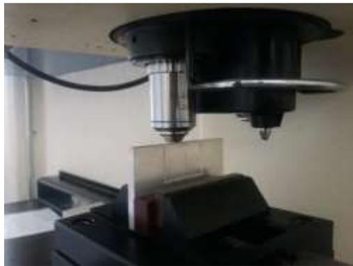
**Figura 3.7** Prueba de dureza Vickers de especímenes con y sin LSP
