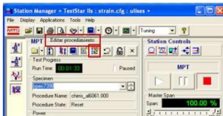
**Figura 3.14** Generador de funciones, editor de procedimiento.
