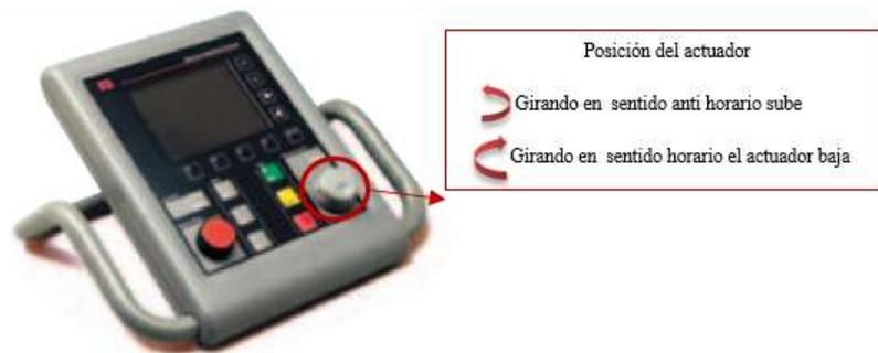
**Figura 3.19** Control Manual del actuador
