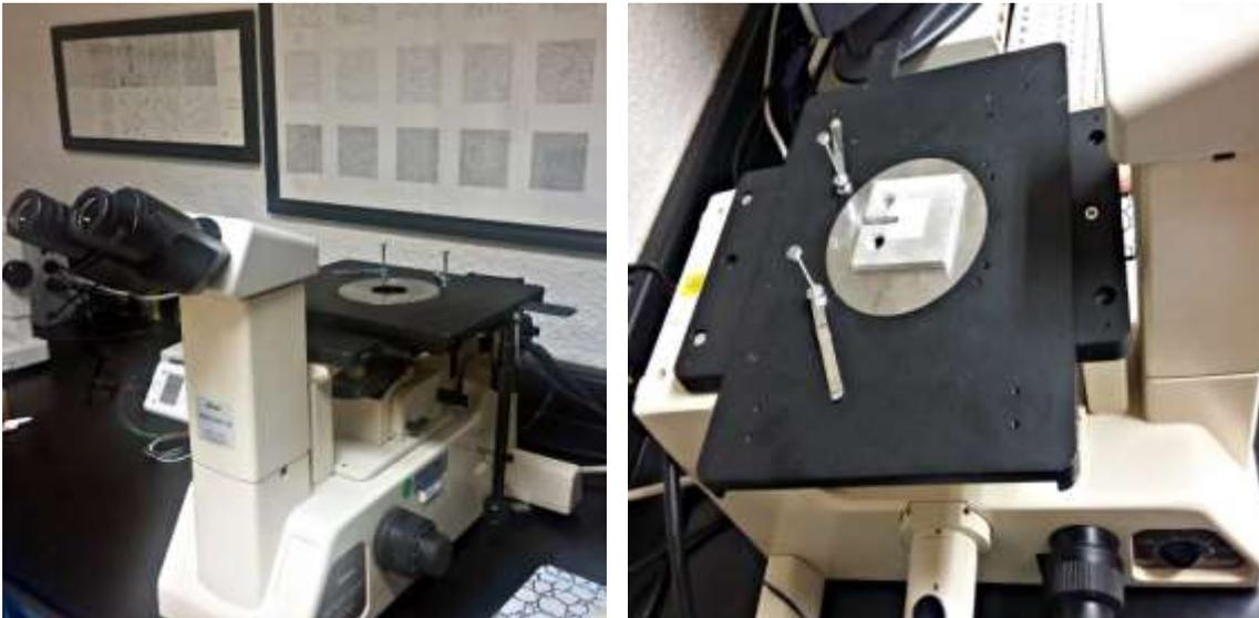
**Figura 3.30** Microscopio metalúrgico invertido EPHIPHOT 200
