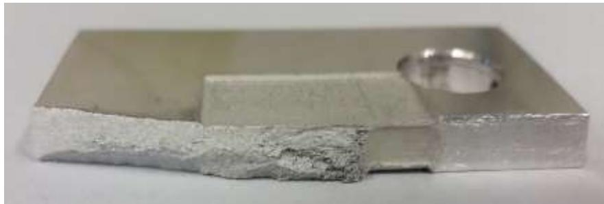
**Figura 3.32** Probeta fatigada con tratamiento LSP
