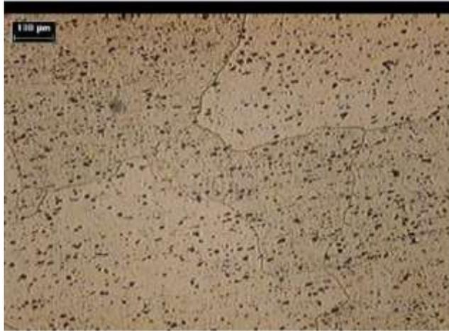
**Figura 2.19** Microestructura de un aluminio 6061 T6 (50X) [9]
