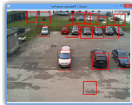
Figura 1.6: La imagen muestra un ejemplo de reconocimiento realizado por el algoritmo Haar-Cascade [4].
