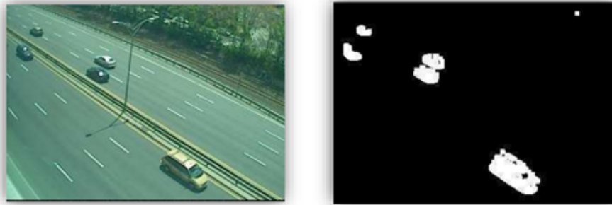
Figura 1.5: La imagen muestra el ejemplo de aplicar el método BS para detectar los autos que transitan por una carretera [3].
