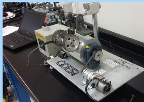
Figura A.2 – Patrón de Calibración de Odómetros. Vista lateral
