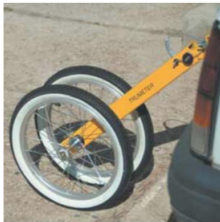
Figura 11.- Odómetros de remolque (quinta rueda).
