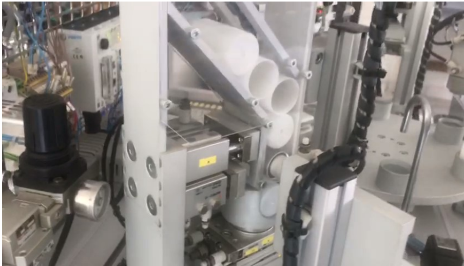
FIGURA 7.5: El cilindro N se activa para rotar el bote y orientarlo a la salida
