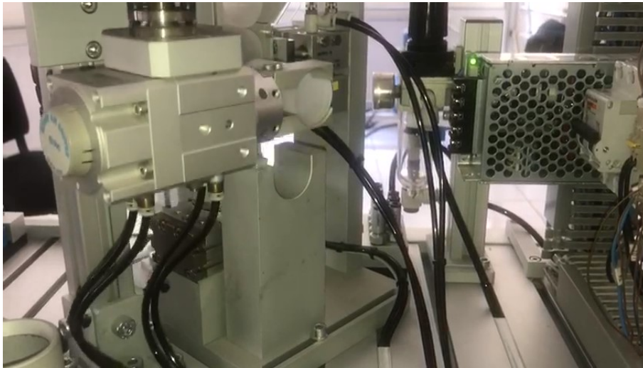
FIGURA 7.8: Subir la pinza, activación de cilindro H
