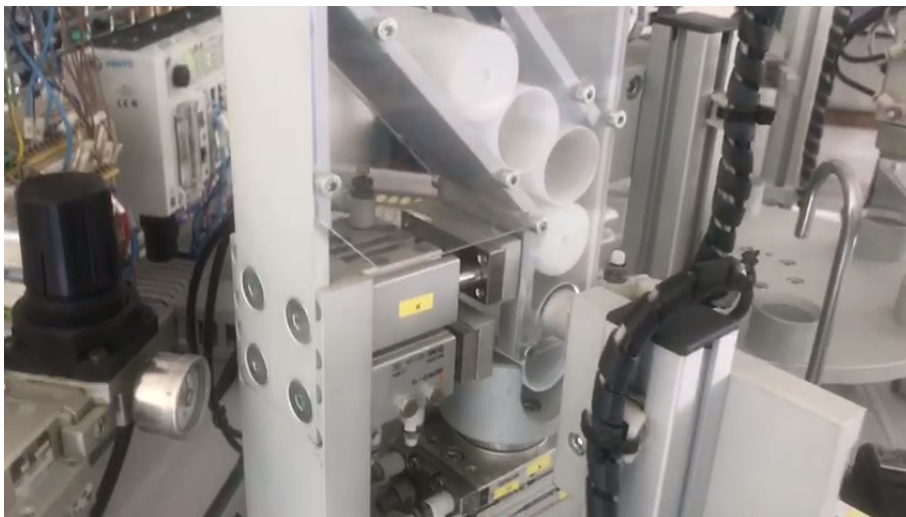
FIGURA 7.4: El cilindro N recibe el bote.
