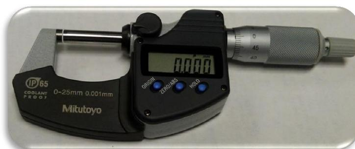
**Fig. A1. Micrómetro de exterior que se intercomparó.**
