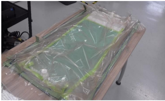
Figura 24. Proceso de embolsado y acomodo de mangueras.
