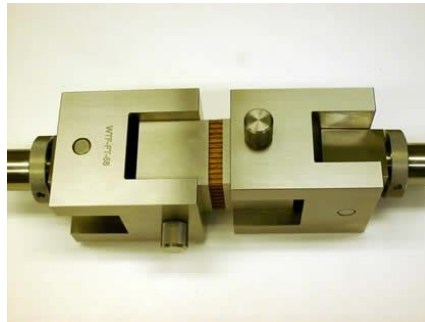
Figura 39. Configuración de ensayo a flexión plana.
