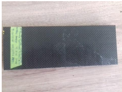
Figura 46. Probeta a flexión terminada.
