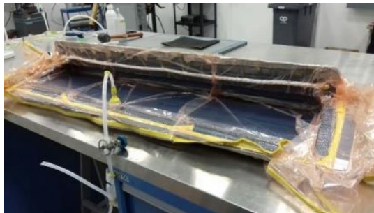
Figura 1. Proceso de infusión. (Fotografía Cortesía CENTA)
