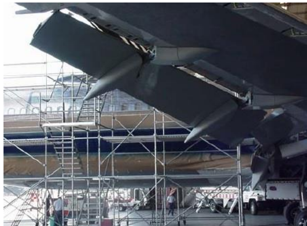
Figura 5. Flaps de un B767 fabricadas en material compuesto tipo sándwich [15].
