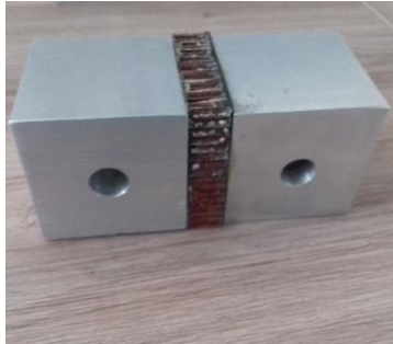
Figura 38. Cubos adheridos a la probeta.
