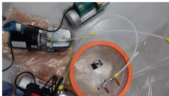
Figura 32. Trampa y bomba de vacío.
