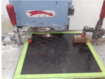
Figura 45. Placa sándwich sometida a corte.
