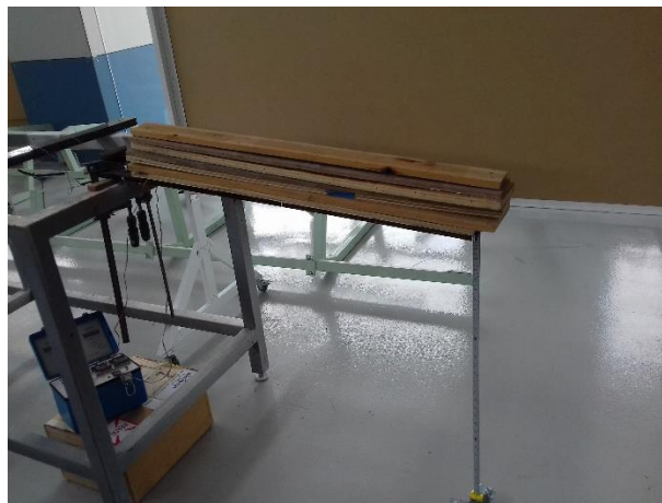
Figura 62. Carga de los pesos sobre la viga en cantiléver.
