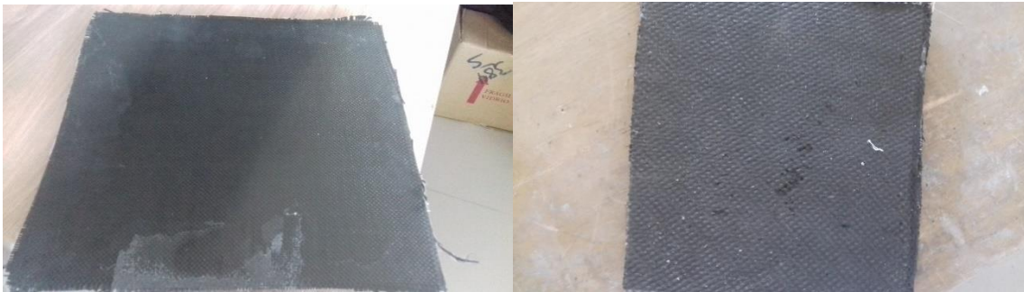
Figura 33. Láminas manufacturadas en VARI fallidas.
