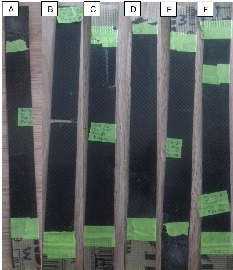
Figura 47. Falla en los laminados.
