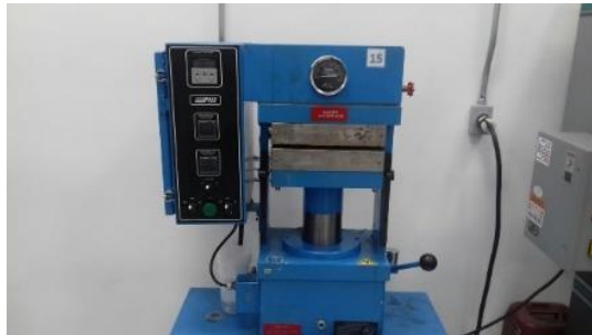
Figura 3. Prensa de RTM. (Fotografía Cortesía CENTA)
