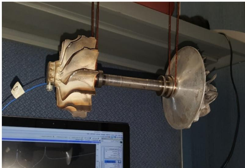
Fig. 3.18. Rotor del turbocargador.
