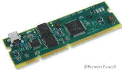
(b) Control card o DSP (procesador digital de señales).
