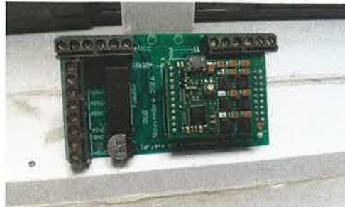
(b) Tarjeta para la adecuación del driver con módulo integrado.
