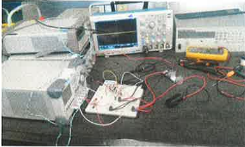
(a) Prueba de los circuitos de activación de los mosfets de potencia.
