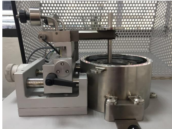
Figura 12. Equipo de tribología pin-on-disk, modelo THT 1000 de Anton para ubicado en el laboratorio de Ingeniería de Superficies y Manufactura Aditiva de CIDESI.
