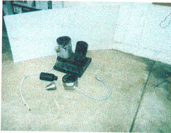
Figura 5.1 Calentadores cerámicos colocados sobre dado de extrusion .
