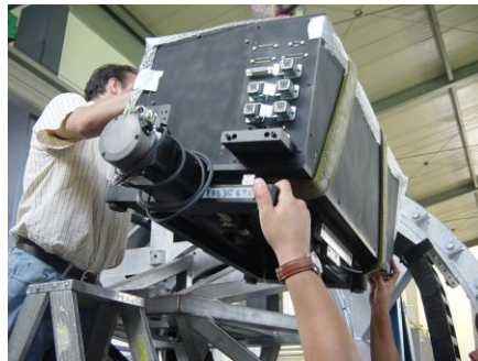
Figura 12.7: Montaje de la caja del instrumento
