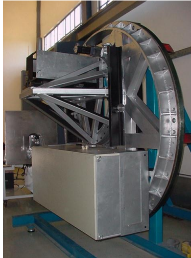
Figura 11.3: Instrumento de verificación con gabinete de la electrónica instalado
