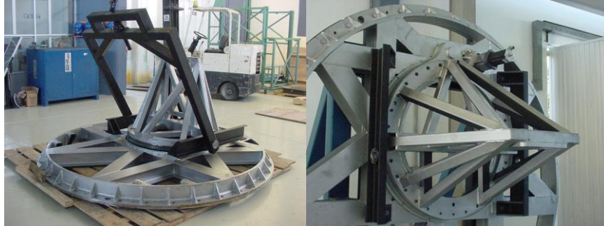
Figura 12.5: Montaje del posicionador en la estructura de transporte y pruebas con el columpio
