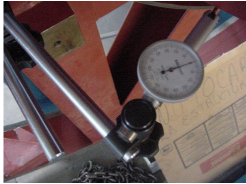
Figura 5.27: Medición del desplazamiento rotacional
