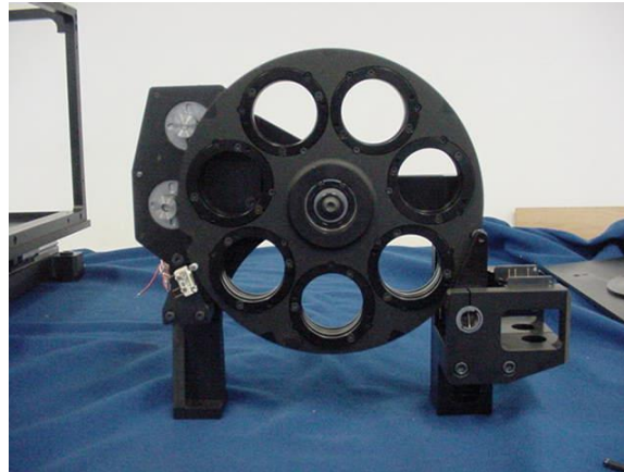
Figura 11.7: Conjunto de ruedas de filtros con motores y switches instalados
