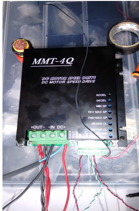
Figura 3.1.5: Controlador MMT-DC24RT100BL adquirido.
