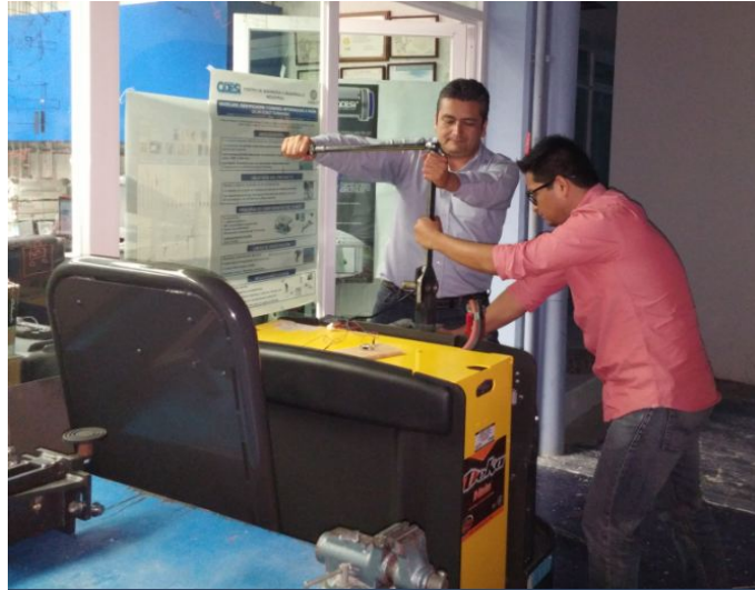
Figura 3.1.3: Pruebas de torque en el vehículo sin movimiento lineal.
