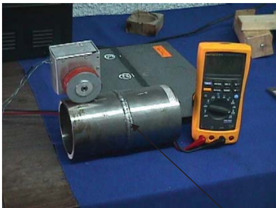
Cordón de soldadura
