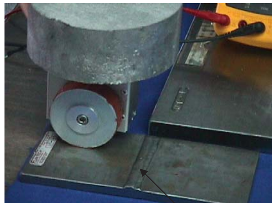
Cordón de soldadura
