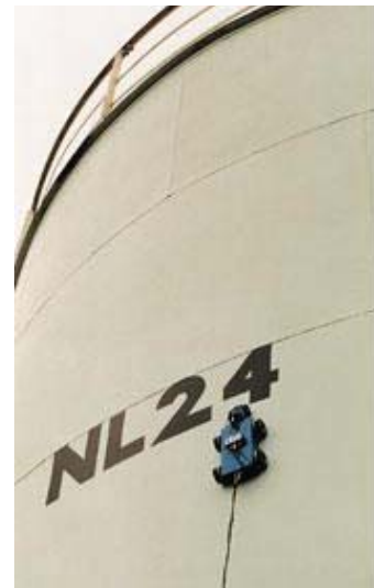
Fig. 1.14 Robot escalando tanque de almacenamiento.
