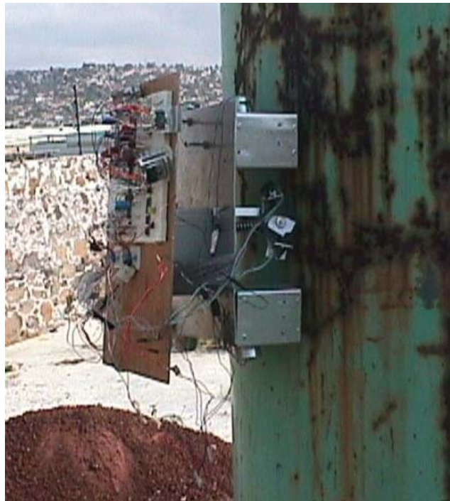
Fig. 5. Prototipo inalámbrico escalando tanque de almacenamiento.
