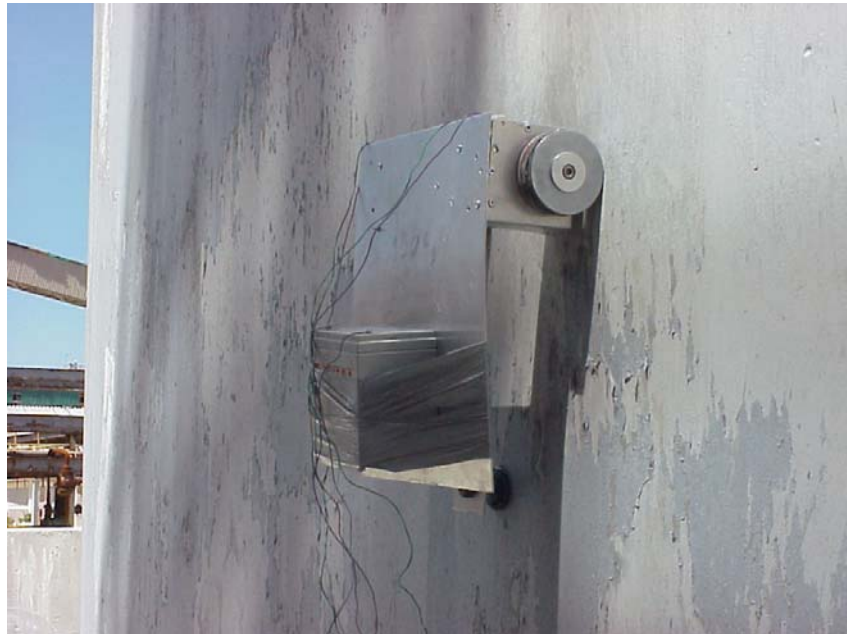
Fig. 5. Prototipo escalando tanque de almacenamiento.
