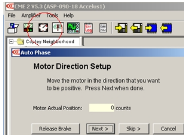
Figura 2.15: Autophase de motores.
