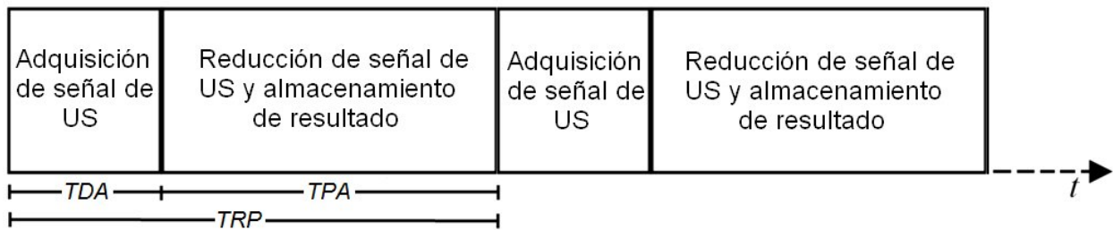
Figura 1.4. Diagrama de tiempos de adquisición y procesamiento de una señal de US.
