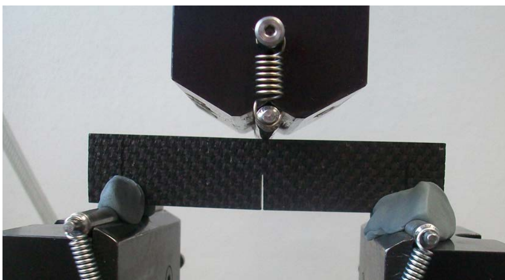
Figure 6.12 : Eprouvette en matériau composite montée pour essais quasi-statique
