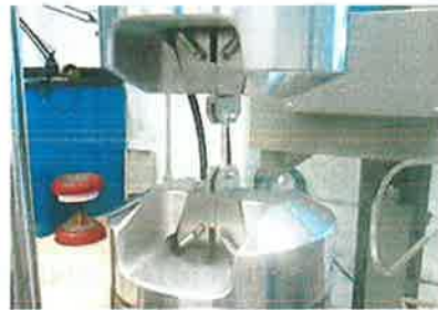
Fig. 4.10. Probeta montada para ensayo de fatiga.
