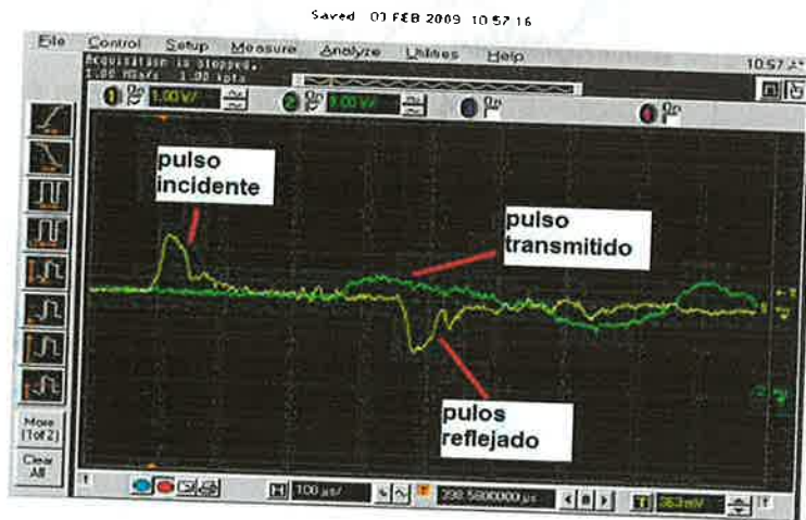
Fig. 3.26. Amplitudes de los pulsos \epsilon_I , \epsilon_R y \epsilon_T .
