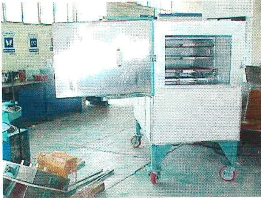
Figura 5.4 Cámara del horno eléctrico de relevado de esfuerzos en resortes.
