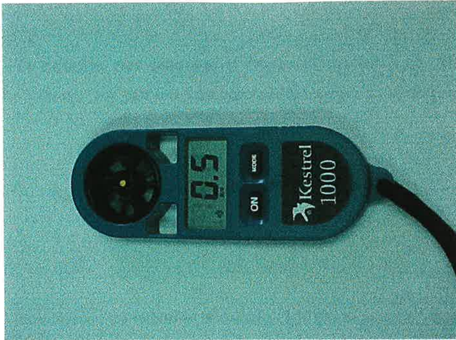
Figura 3.2 Anemómetro utilizado para medir el flujo de la turbina.
