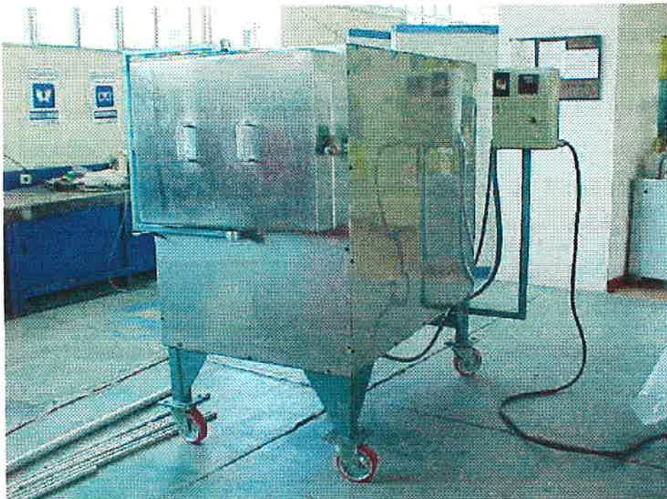
Figura 5.5 Horno eléctrico de relevado de esfuerzos en resortes.
