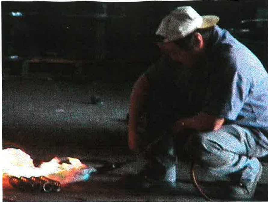
Figura 2.2 Persona encargada de realizar el Relevado de esfuerzos de resortes a fuego directo con soplete en la actualidad.
