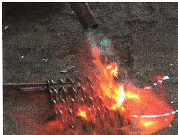
Figura 2.1 Resortes que están siendo Relevados a fuego directo con un soplete.
