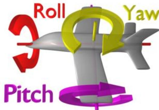
Figura 29: Coordenadas de orientación del diablo geómetra.
