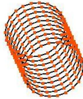
Figura 32: Generación de vértices representando una tubería.
