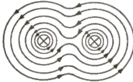
Figura 2.3 – Efecto de las Corrientes Paralelas Directas [4].
