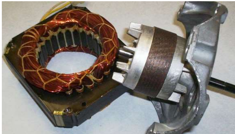
Figura 2.7 - Estator (izquierda) y rotor (derecha) en un motor de inducción.
