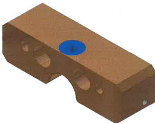
Fig 3-9. Puente soporte de tubo.
