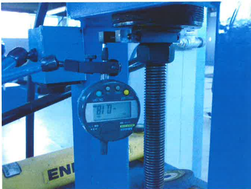
Figura 6.5 Colocación del indicador digital para checar la profundidad de penetración
