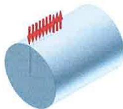
Fig. 5-16 Representación de las fuerzas aplicadas en el perno
