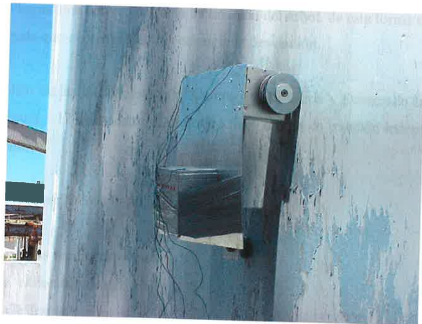
Figura 5.11 Prototipo de 2 ruedas subiendo por un tanque de almacenamiento.
