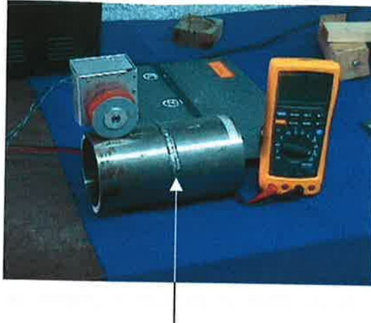
CORDON DE SOLDADURA
