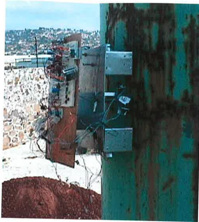
Figura 5.12 Prototipo inalámbrico subiendo por un tanque de almacenamiento.
