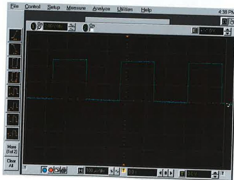
Figura 5.5 Señal PWM usada para el control de los motores de la prueba.
