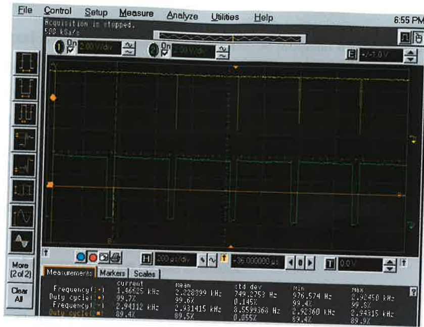
Figura 5.9 Diferencia del ciclo de trabajo de la señal PWM usada para el control de inclinación del robot.
