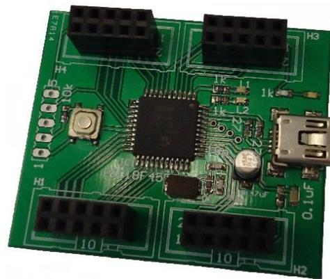
Figura 3.9. Tarjeta de adquisición de datos (DAQ).
