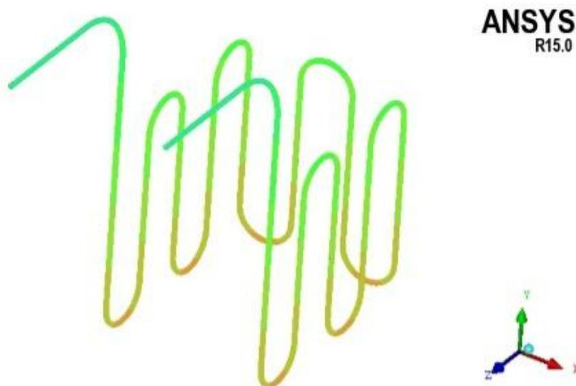
Figura 5.2. Premallado general de la geometría del ICGHI en ICEM CFD.
