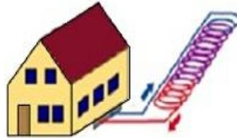
Figura 2.11. Intercambiador de calor geotérmico modalidad slinky.
