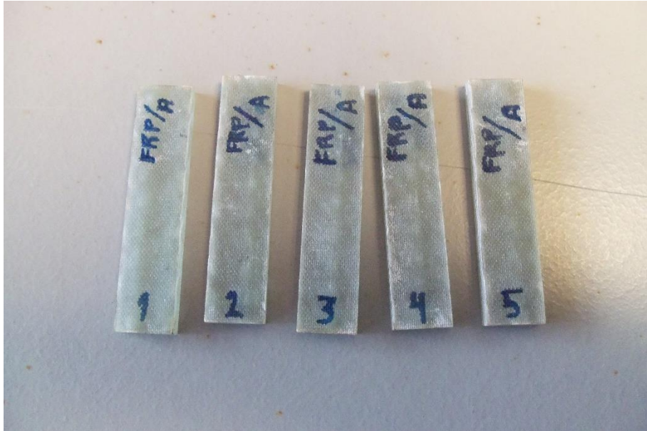
Figura 31. Probetas para DMA manufacturadas por autoclave.
