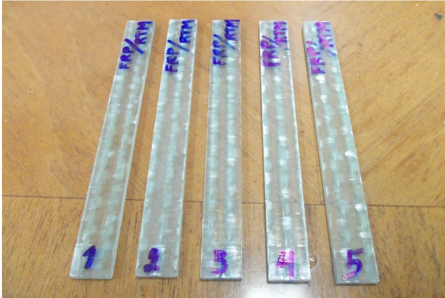
Figura 25. Probetas de flexión manufacturadas por RTM.
