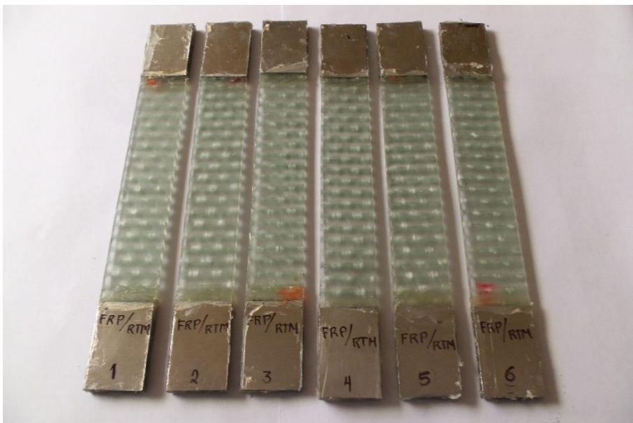
Figura 20. Probetas de tensión manufacturadas por RTM.
