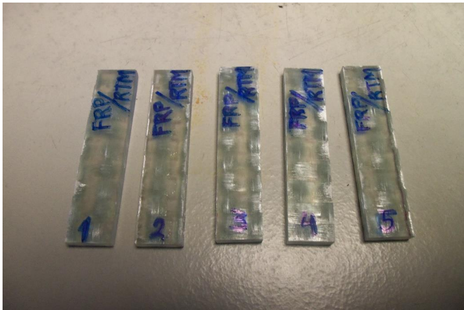
Figura 30. Probetas para DMA manufacturadas por RTM.
