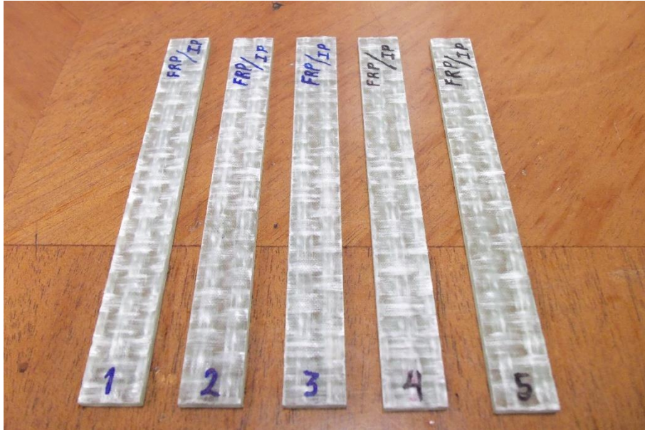
Figura 23. Probetas de flexión manufacturadas por infusión-presión.
