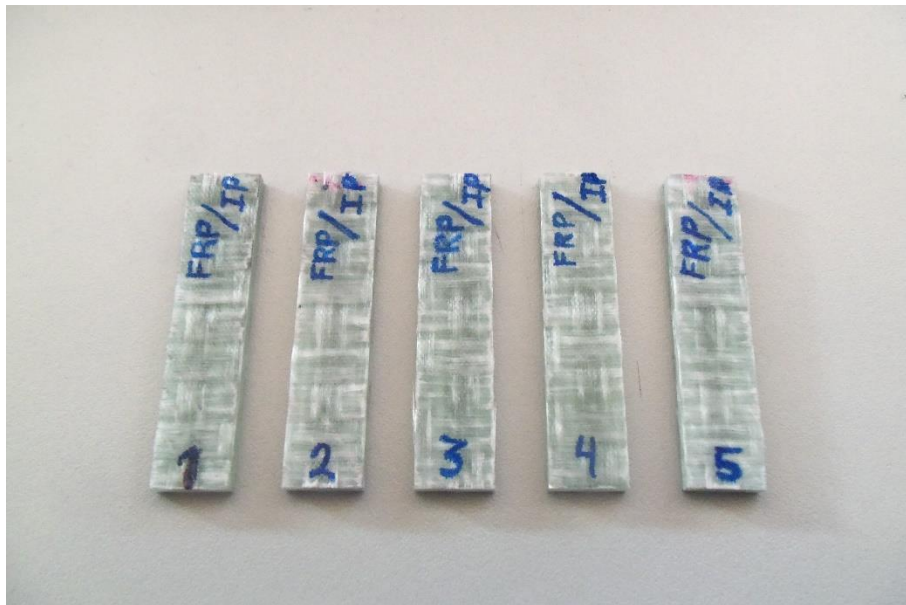
Figura 28. Probetas para DMA manufacturadas por infusión-presión.
