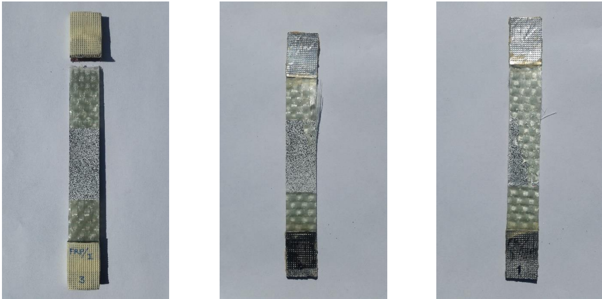
Figura 60. Probetas representativas analizadas por DIC. A) infusión, b) infusión-presión e c)infusión-presión-temperatura.
