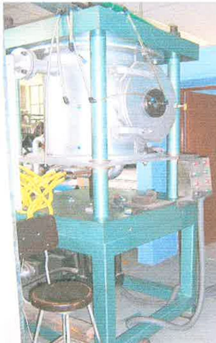
Fig. 2. Máquina de sinterizado por chispa
