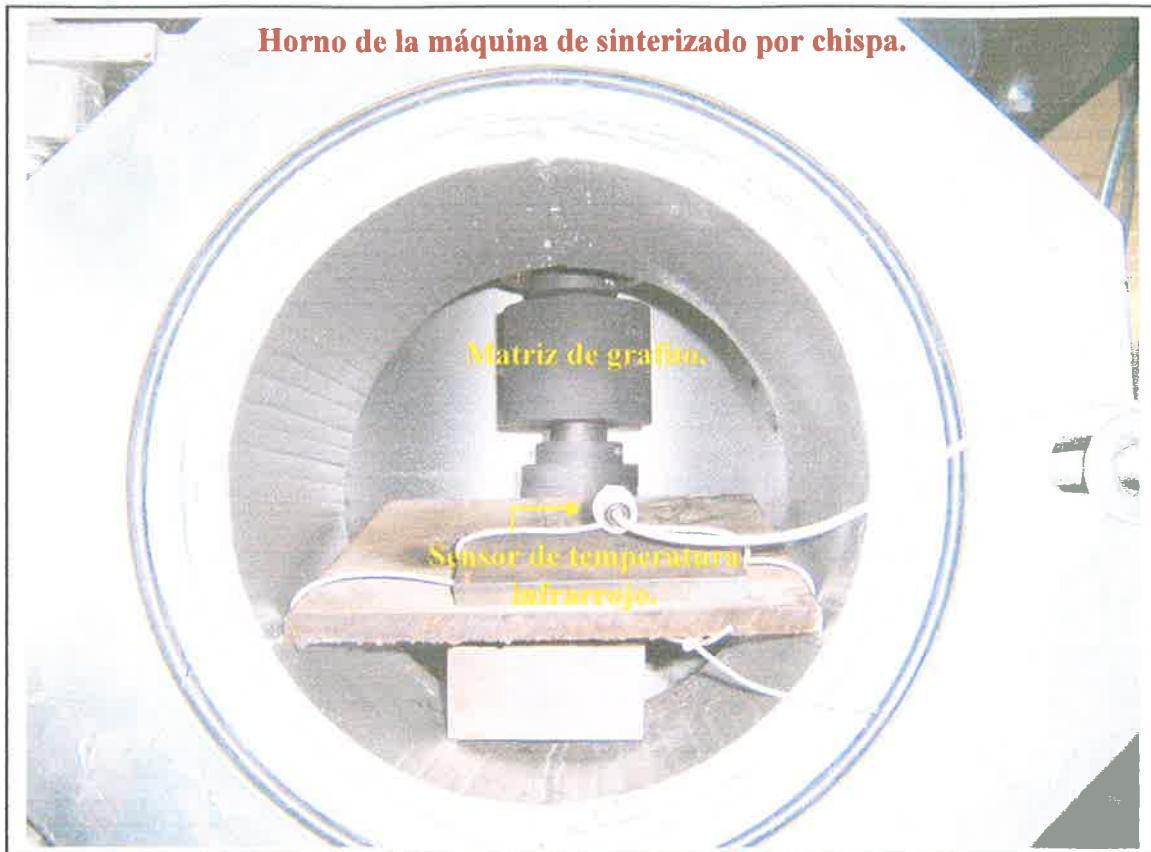
Fig. 10. Sensor de temperatura infrarrojo, ubicado en dirección a la matriz de grafito, para medir su temperatura.
