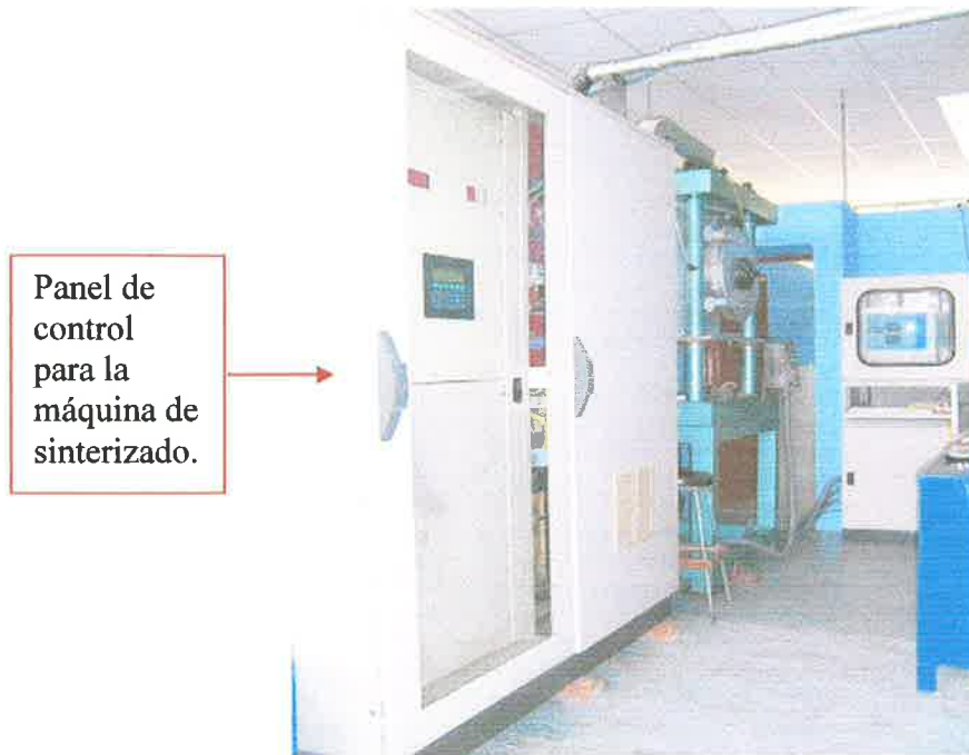
Fig. 3. Panel de control para la máquina de sinterizado
