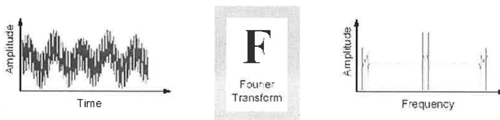
Figura 2.18 Esquema de la Transformada de Fourier
