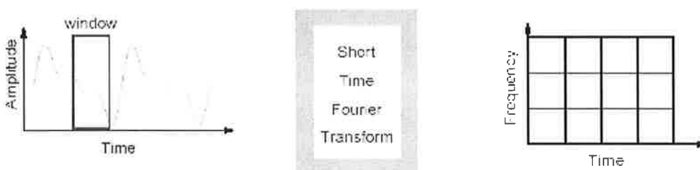
Figura 2.19 Esquema de la Transformada de Fourier de tiempo corto
