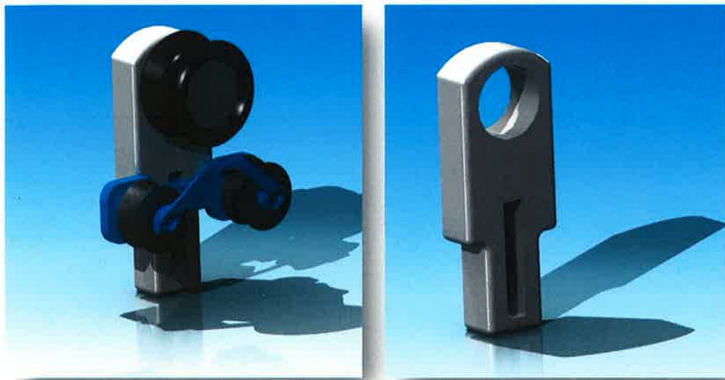
Fig. 20 Estructura de cuerpo para la articulación diseñada
