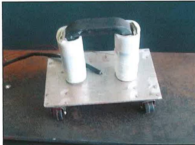
Fig.18.- Equipo de inspección por fuga de campo magnético
