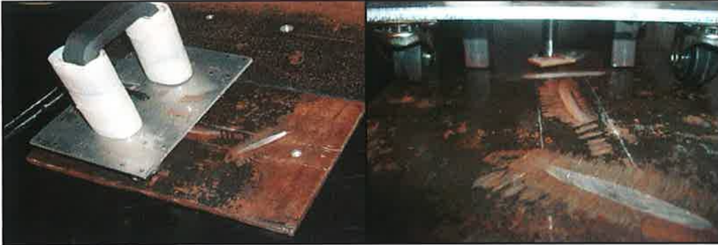
Fig. 42.- Inspección en diferentes probetas, para detectar fuga de campo magnético
