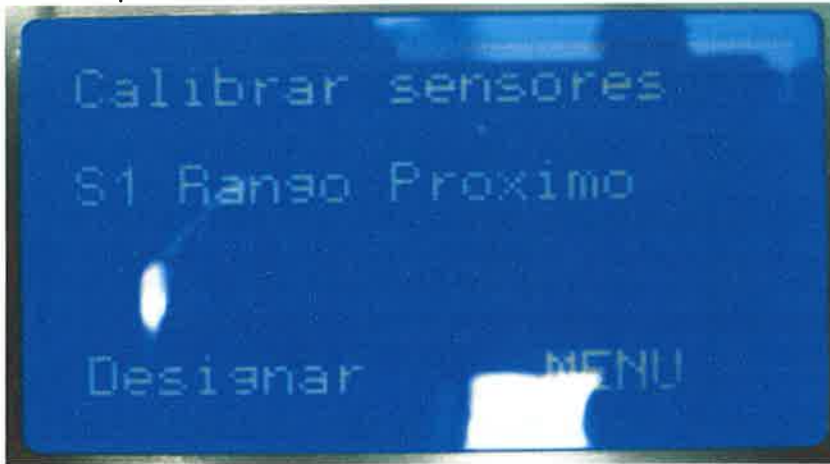
Fotografía 6: Opción de Calibrar Sensores para sensor 1 cercano
