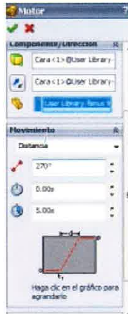
Figura 2.7: Parámetros del motor.
