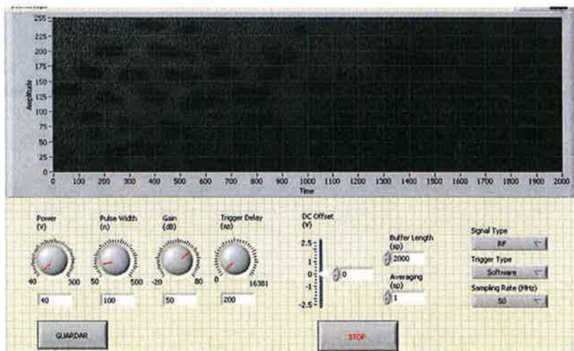
Imagen 12: Panel frontal del USB UT-350.
