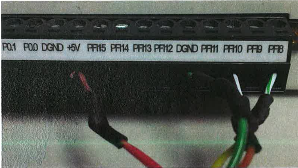
Imagen 25: Diagrama de conexión del encoder a la DAQ.
