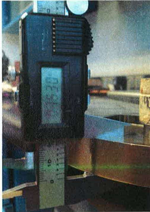
Imagen 40: Ahora podemos apreciar la medición del espesor de 0.75 pulg hecho con un vernier sobre el bloque de calibración.
