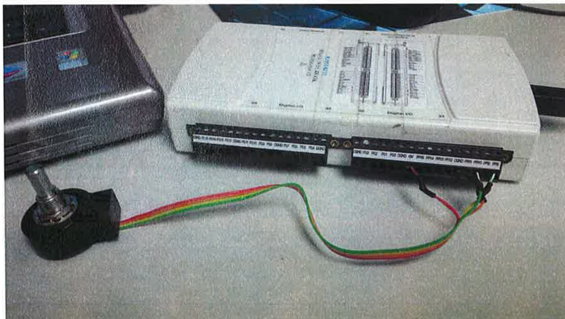
Imagen 45: Encoder incremental conectado a la DAQ, y posteriormente a la PC.
