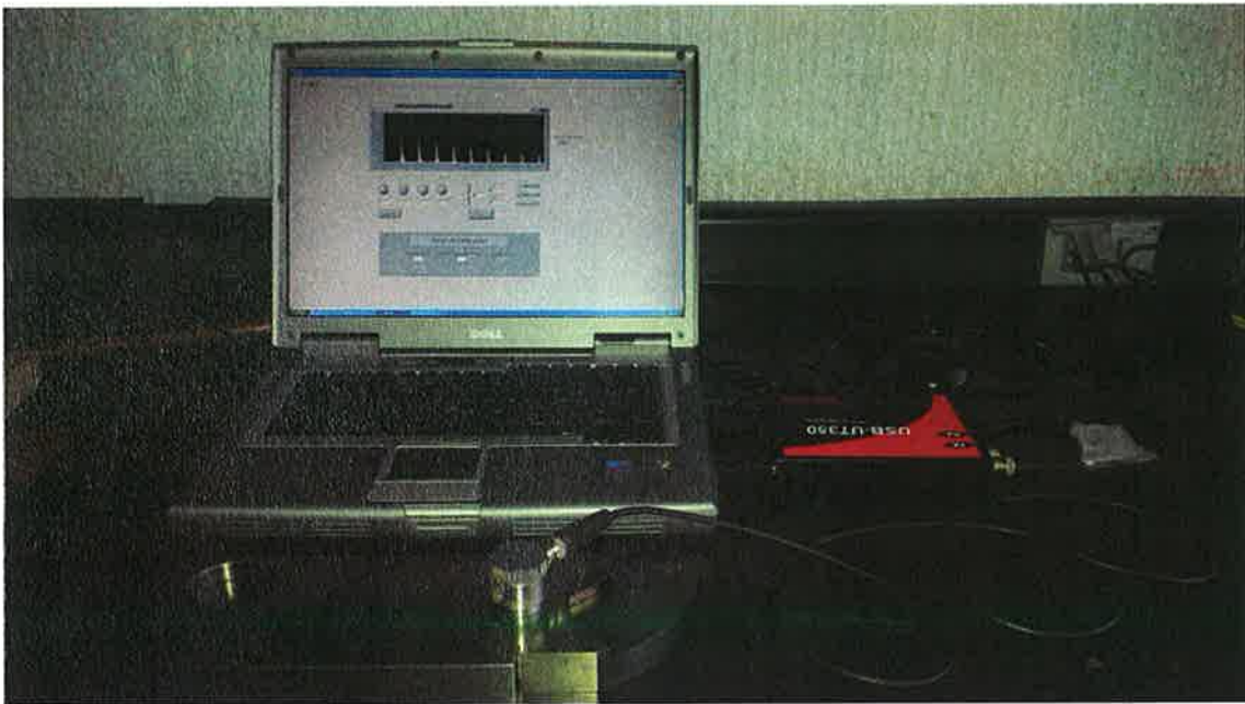
Imagen 32: Figura del bloque de calibración, y en la pantalla de la computadora, se observan los ecos de la pared posterior, para una profundidad de 1 pulg.
