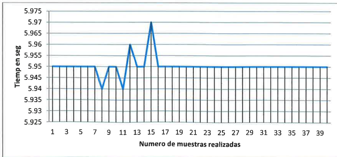
Figura 4.14 Representación gráfica de tiempos en que se ejecuta el borrado de toda la memoria.
