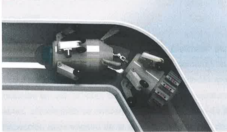
Figura 27. Disposición física del funcionamiento de la junta universal.
