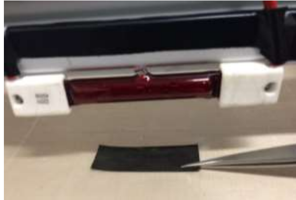
Figura 25 Lámpara IR expuesta a la Fibra de Carbono
