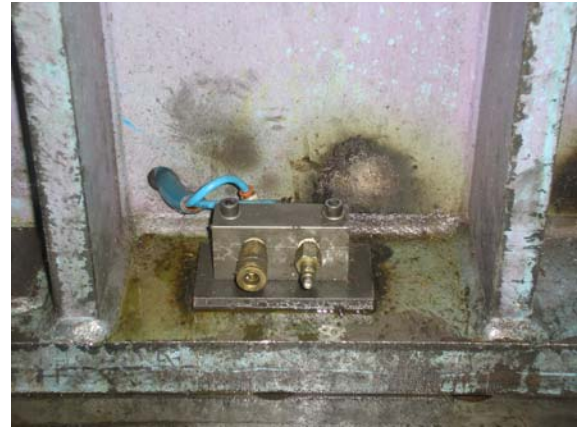
Figura 6.2-3. Conector eléctrico y neumático troquel A34.
