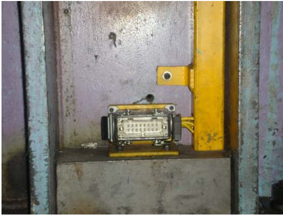
Figura 6.2-3. Conector eléctrico y neumático troquel A34.
