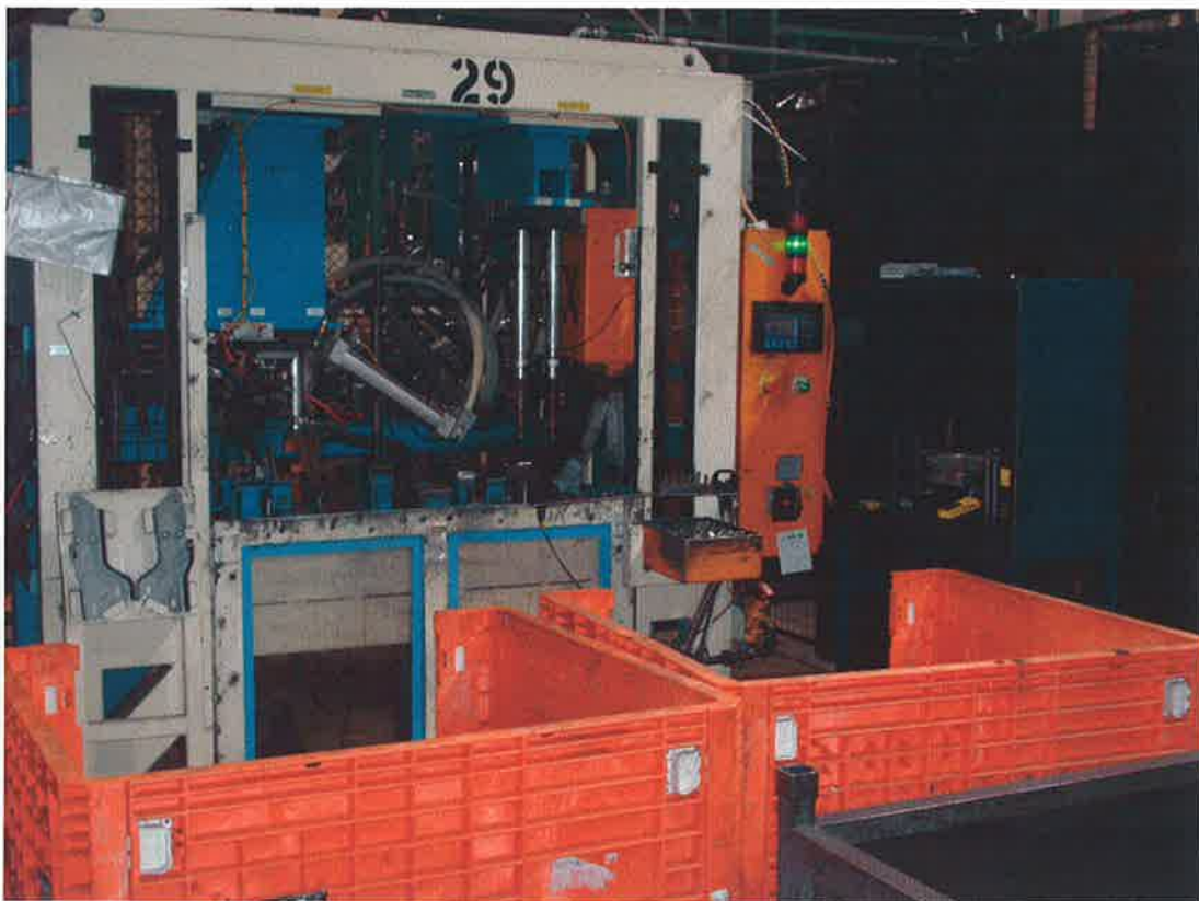
Fig. 4 Estación de soldadura Center Bracket con mesa poka-yoke.
