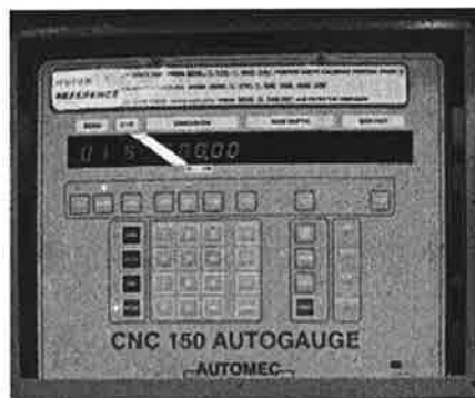
FIGURA 18. CAJA DE CONTROL DEL ESCANTILLÓN
