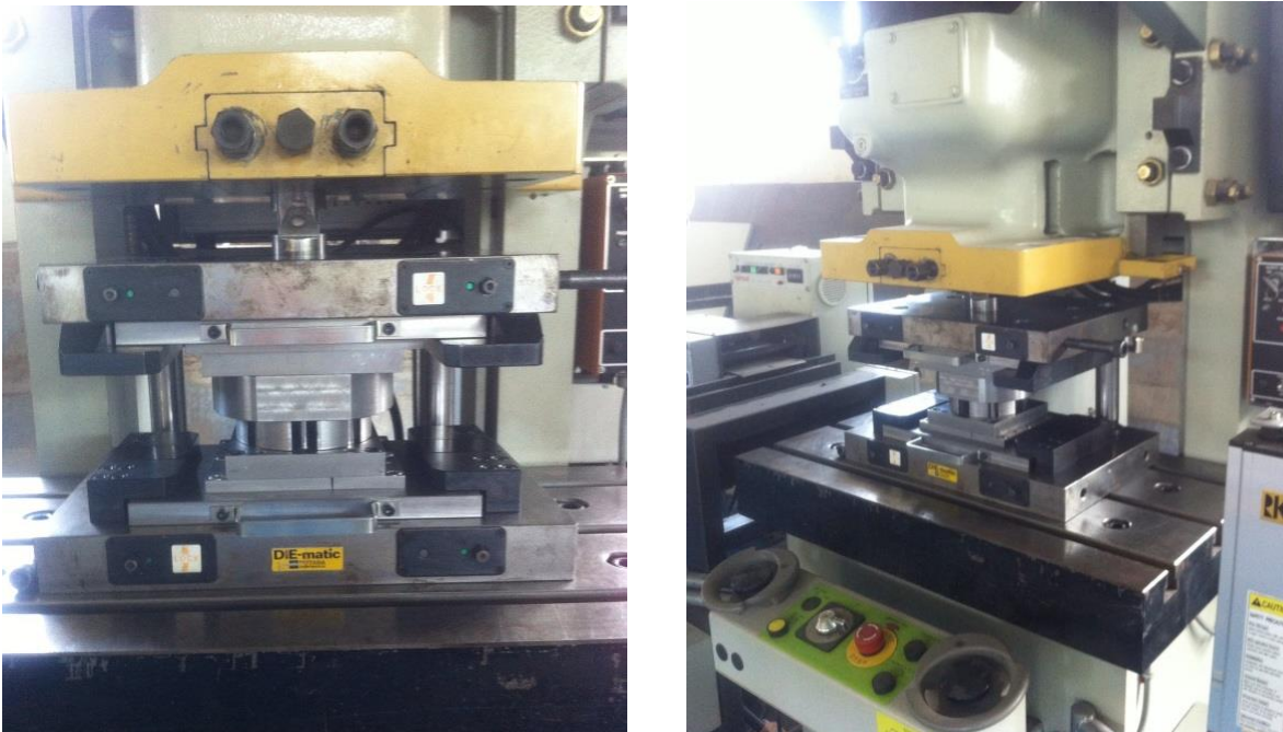
Figura 4.14. Pruebas del herramental de corte en la prensa servo Komatsu.
