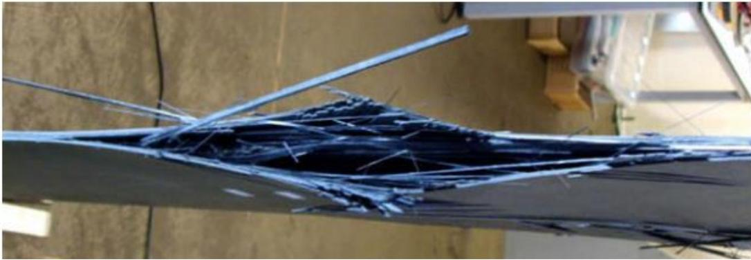
Figura 18. Falla de espécimen de pruebas provocada por la delaminación entre capas.
