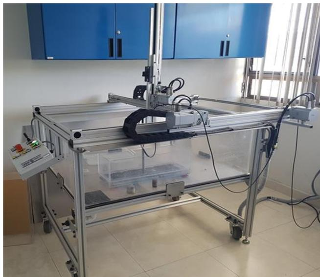
Figura 42. Equipo de Ultrasonido C-Scan.
