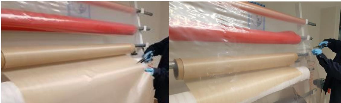
Figura 23. Corte de materiales para fabricación de bolsa de vacío
