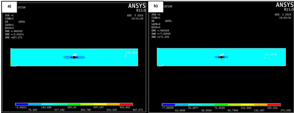
Figura 66. Campos de deformaciones y esfuerzos ( $S_x$ ), a) Lámina 1, b) Lámina 2.
