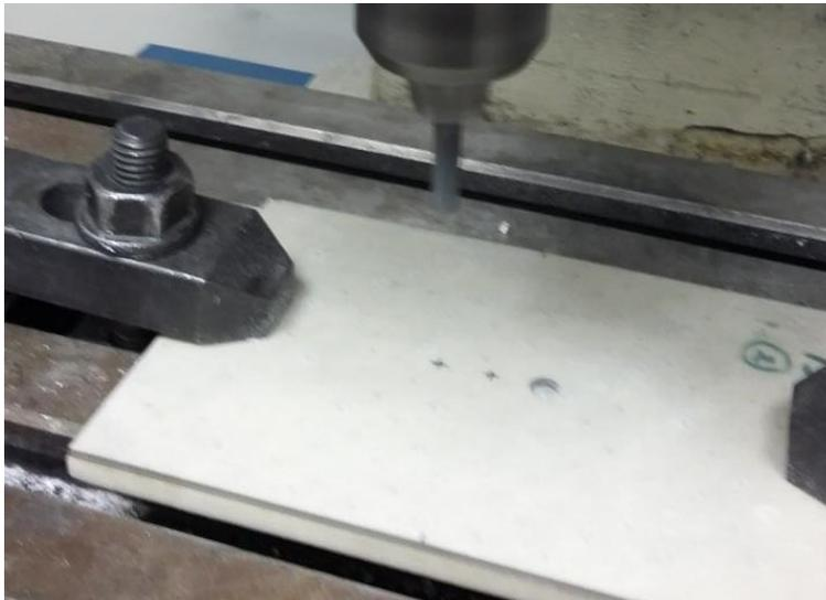
Figura 34. Barrenado de especímenes.
