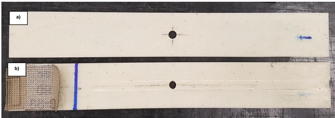
Figura 45. a) Espécimen de fibra de vidrio unidireccional antes de realizar la prueba de tensión. b) Falla del espécimen de fibra de vidrio unidireccional por tensión cuasi-estática.
