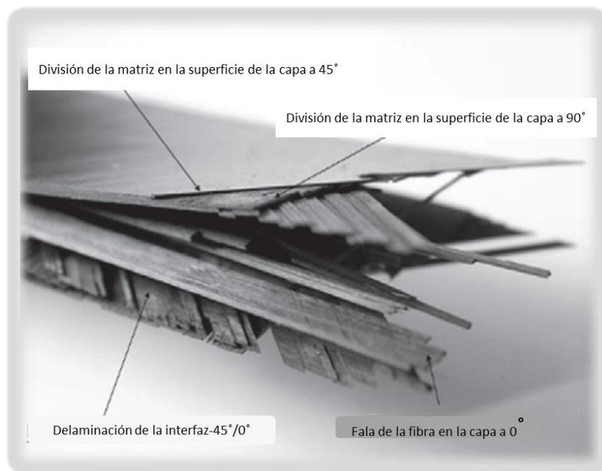
Figura 16. Tipos de daño en un laminado de material compuesto [43].
