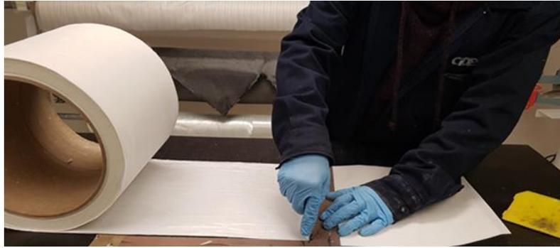
Figura 25. Corte de láminas de material de material pre-impregnado de fibra de vidrio.
