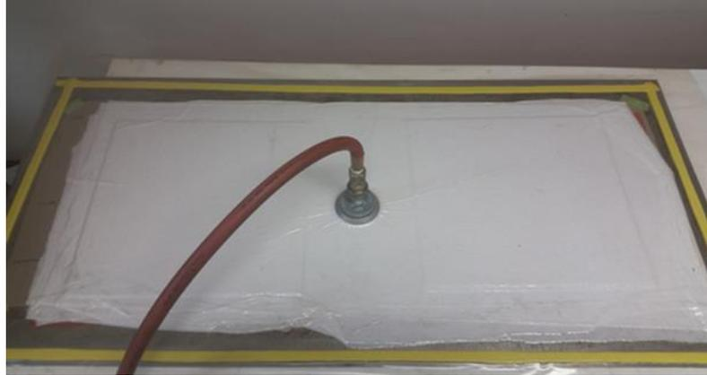
Figura 27. Configuración final de la bolsa de vacío.
