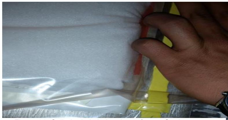
Figura 26. Sellado de la bolsa de vacío con *Sealant tape*.
