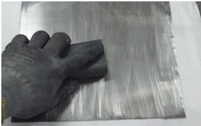
Figura 19. Abrasión manual a lámina de aluminio.
