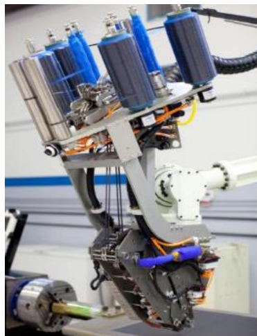
Fig. 1: Sistema AFP. Cortesía de Automated Dynamics
