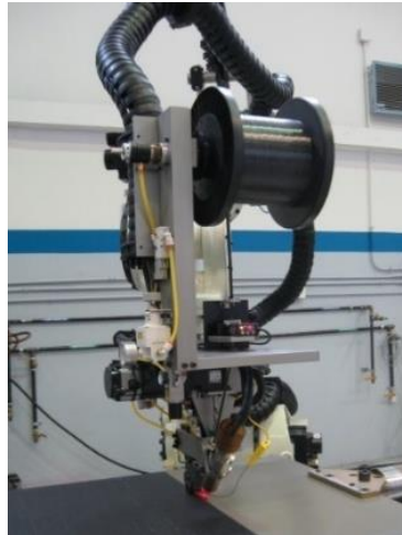
Fig. 8: Montaje del carrete de fibra en forma horizontal. DLR
