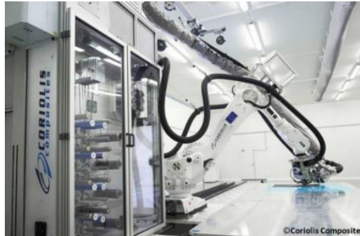
Fig. 10: Montaje de carretes en alojamiento acondicionado. Coriolis Composites
