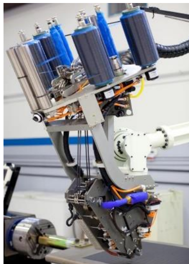
Fig. 9: Montaje del carretes de fibras en forma vertical. DLR
