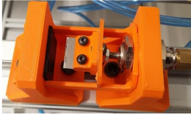
Fig. 34: Vista superior del sistema de corte para experimentos
