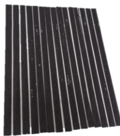
Fig. 71: Tiras de fibra de carbono prepreg de 12.7 mm
