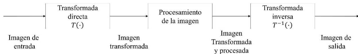
Figura 2.2. Diagrama del procesamiento de imágenes usando transformadas
