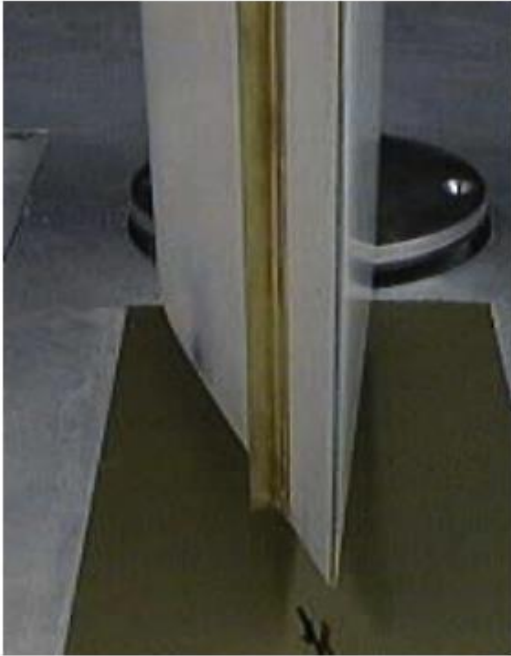
Figura 21. Sección de prueba con Microtab fijo y microtab retráctil.
