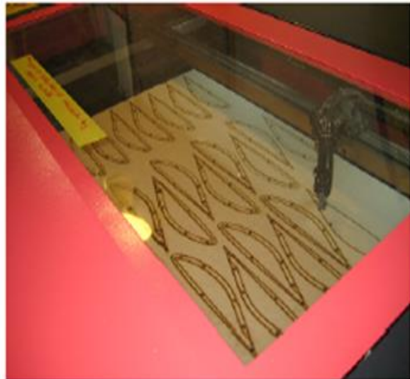
Figura 22. Corte secciones cortadora laser.
