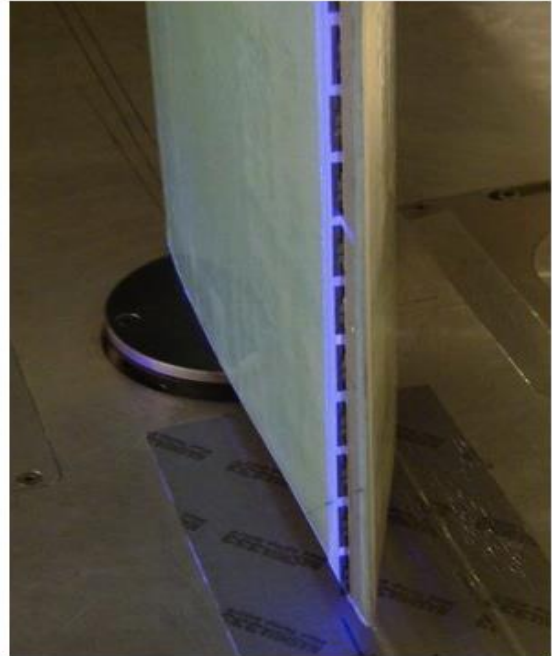
Figura 21. Sección de prueba con Microtab fijo y microtab retráctil.
