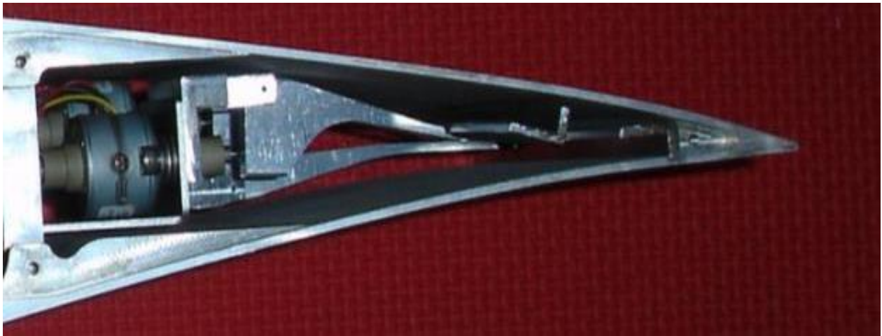
Figura 20. Detalle del modelo de dos secciones sistema de Microtab.
