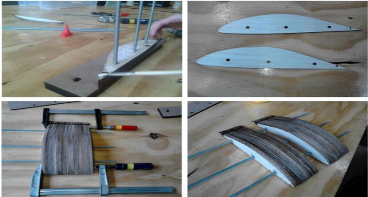
Figura 23 Manufactura sección de prueba, unión de perfiles.
