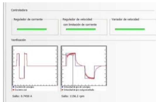
Figura 21. Respuesta de los servomotores Maxon
