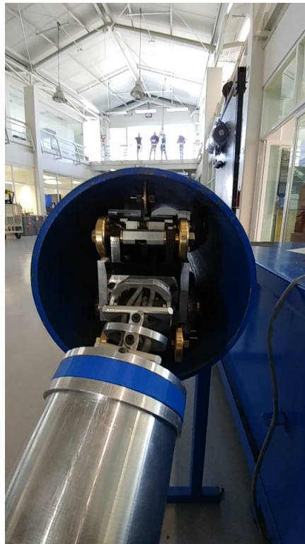
Figura 39. Pruebas preliminares de tracción interna tubo completo
