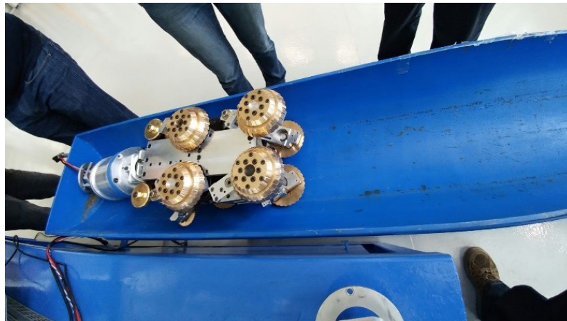
Figura 38. Pruebas preliminares de tracción interna a medio tubo
