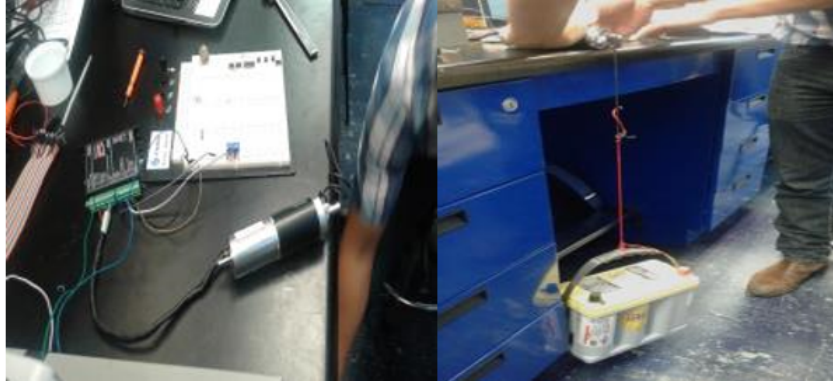
Figura 18. Pruebas de carga y torque de servomotores
