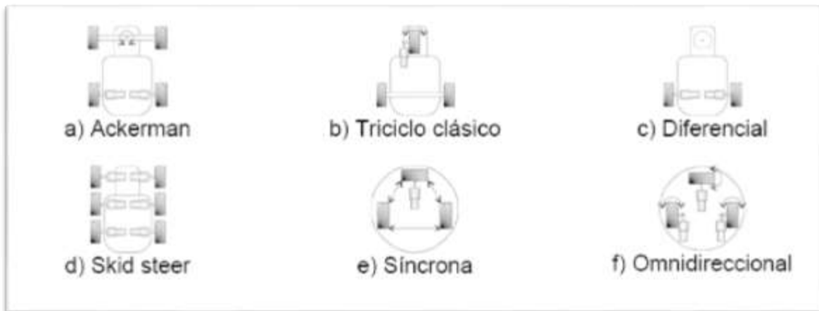
Figura 3. Configuración de ruedas para distintas aplicaciones.
