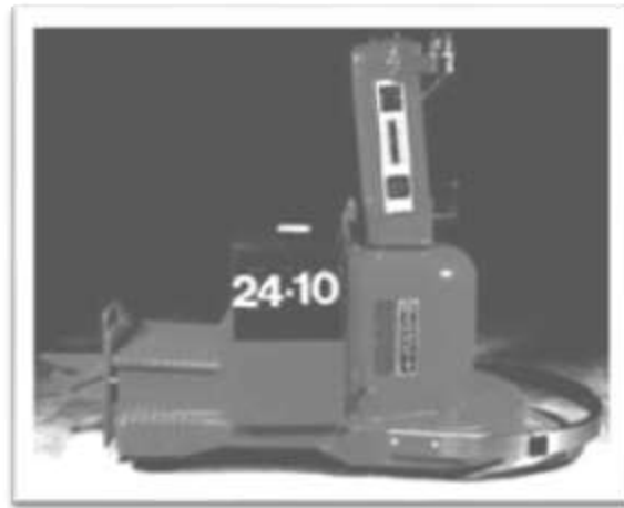
Figura 1. Primer diseño de un AGV por Barrett Electronics.
