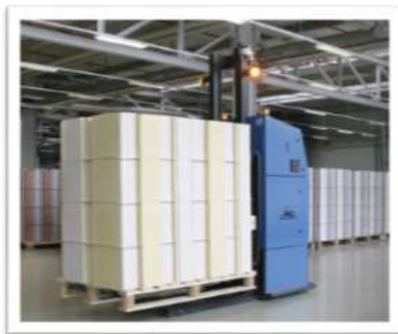
Figura 12. AGV transportador multipalets para cargas considerables.
