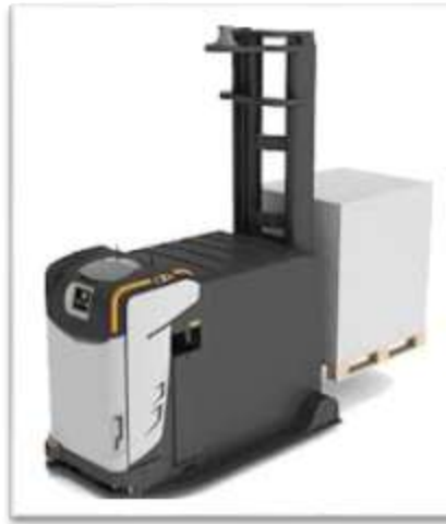
Figura 7. AGV tipo contrapeso con una mayor capacidad que el apilador convencional.
