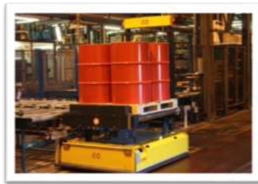
Figura 9. AGV transportador para carga/descarga por medio de rodillos.
