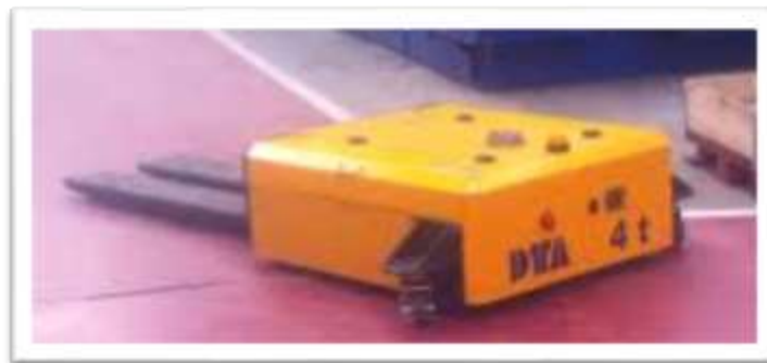
Figura 5. AGV tipo transpaleta usado elevar cargas a ras de suelo.
