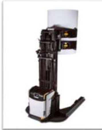
Figura 11. AGV transportador de bobina de papel de forma vertical.
