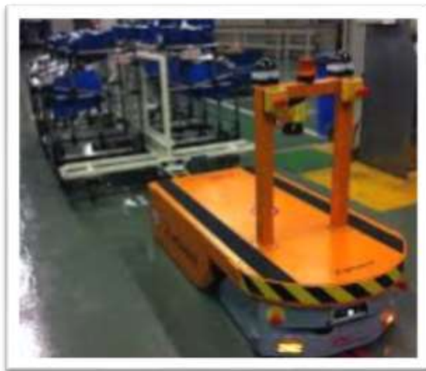
Figura 13.1 AGV tipo tractor para remolcar gran cantidad de peso y volumen.
